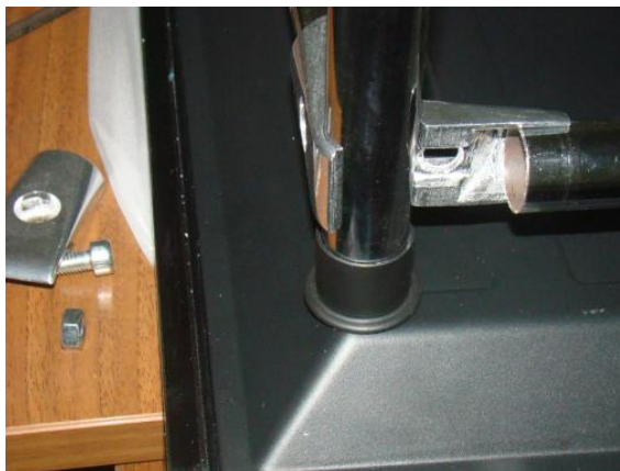
Рисунок 3. Пример установки задней ножки в соединителе
